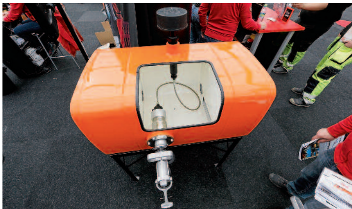
Gjennomskåret drivstofftank som viser Fast Fuel på utsiden og innsiden av tanken. Denne sto på standen til Nasta.
